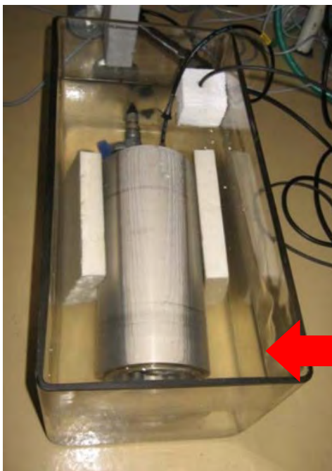
Test těsnosti tlakového výměníku pro tlakování CO 2 až do 10 MPa
