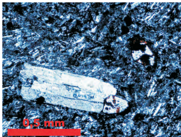
Obr. 5. Pseudomorfézy po olivínu a vyrostlice živce v bazaltickém andezitu na sz. okraji lomu (zkřížené nikoly).
