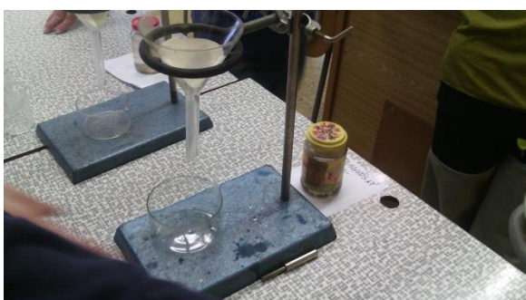
Obr.č.15 Filtrace vzorků vody
