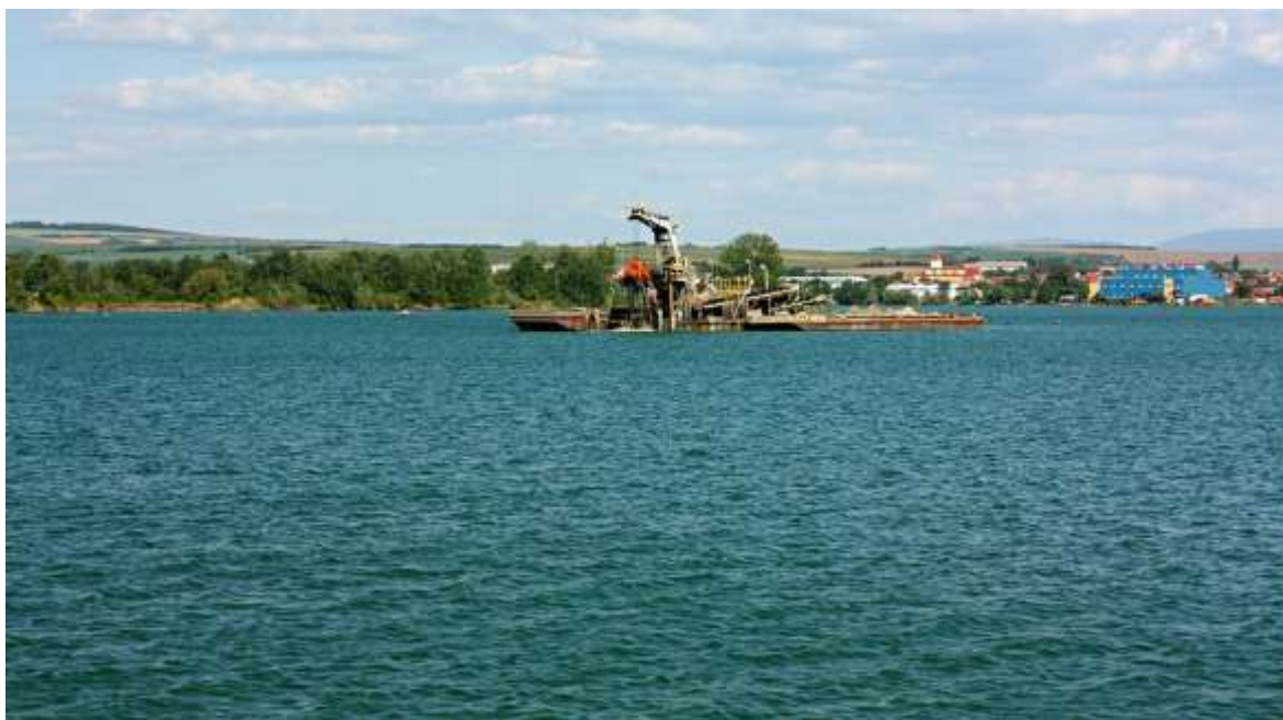
Obr. 4 Těžba štěrkopísku – plovoucí rypadlo
