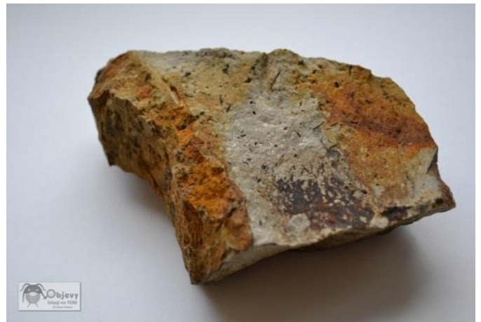
Obr. 22 Andezit se stopami koroze
