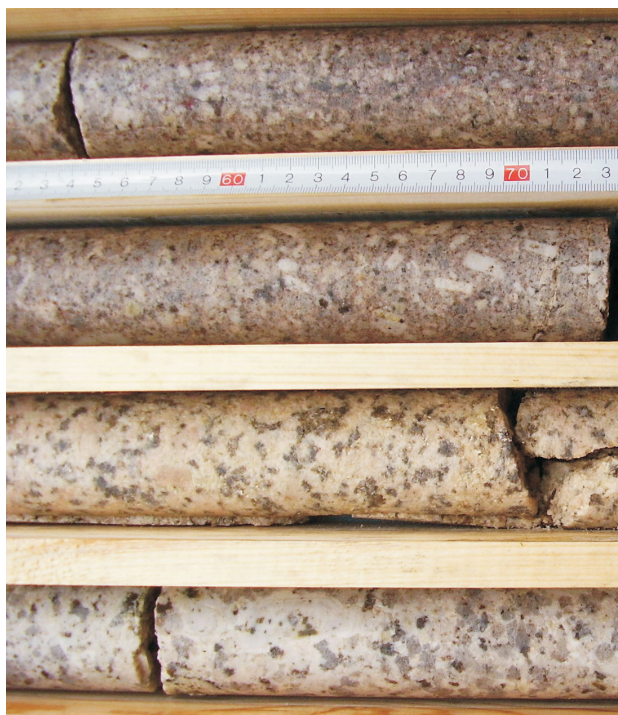
Obr. 2. Ukázka vrtného jádra. Shora: hematitovaný drobně porfyritický granit z metráže 25,51–25,73 a 26,51–26,73 m; narůžovělý hrubě zrnitý slabě porfyritický granit – 27,51–27,73 m; světlý hrubozrnitý typ bez alterace – 28,51–28,73 m.
