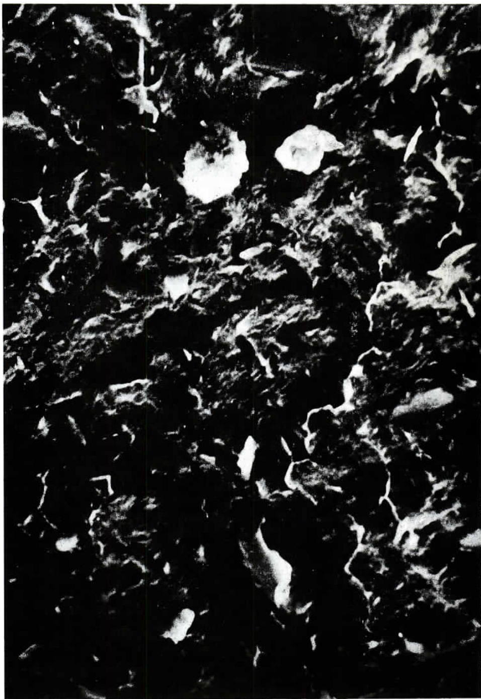
Jíl GE, snímek z rastrovacího elektronového mikroskopu, zvětšení 1 000 \times Foto na příl. III—XVI H. Novotná
