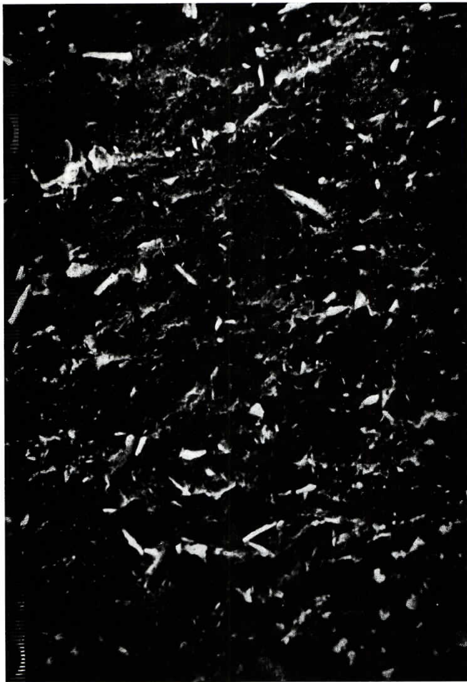
Jíl GE, snímek z rastrovacího elektronového mikroskopu, zvětšení 600 \times
