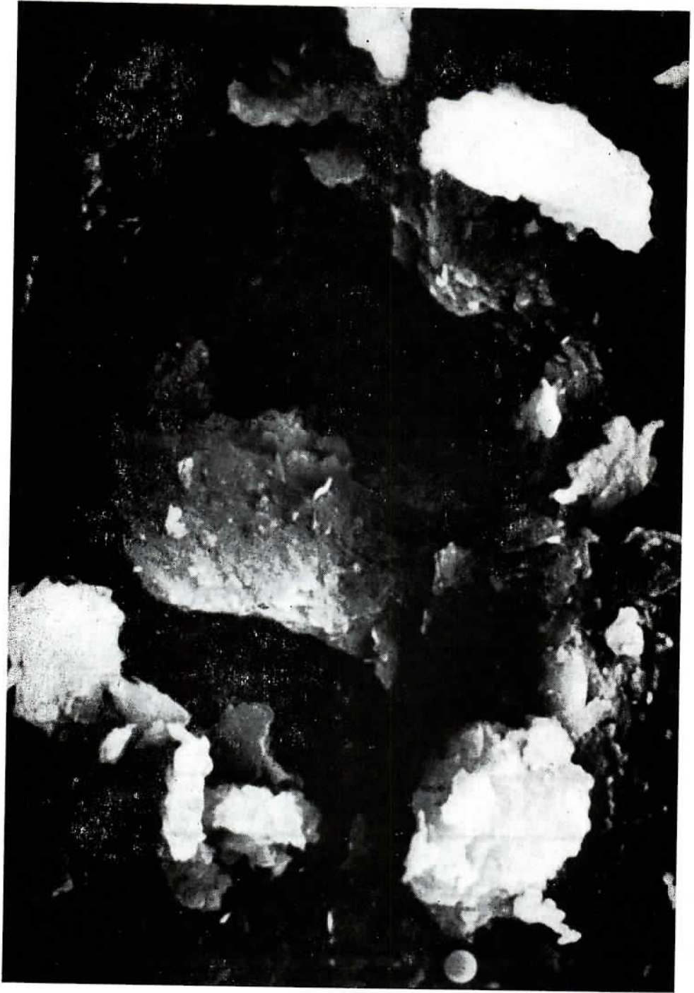
Jíl W1, snímek z rastrovacího elektronového mikroskopu, zvětšení 4 000 \times
