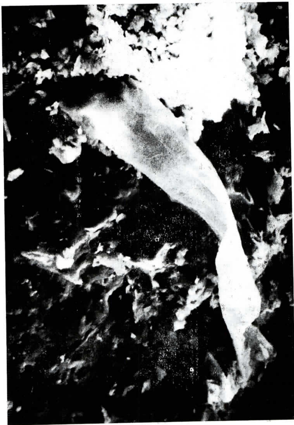
Jíl Kb, snímek z rastrovacího elektronového mikroskopu, zvětšení 600 \times
