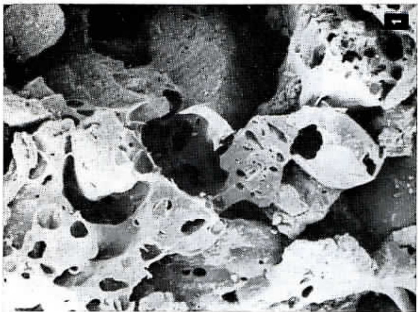
1. Sušimek lomové plochy koksu ze sypané vlhké vsázky uhlí kódu 422 vzniklého při rychlosti ohřevu 2,9 °C/min. Zvětšeno 50 \times , rustrovací elektronový mikroskop. Snímky v příl. I, II a sušimek 1 v příl. III byly pořízeny rovněž z koksu z vlhké vsázky, stejným způsobem, avšak koksy se liší hodnotou rychlosti ohřevu, při které byly získány 2. Lomová plocha koksu — rychlost ohřevu 4,0 °C/min.
