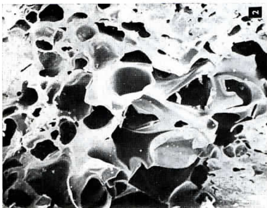
1. Lomová plocha koksu — rychlost ohřevu 14,3 °C/min 2. Snímek lomové plochy koksu ze sypané suché vsázky uhlí kódu 422 vzniklého při rychlosti ohřevu 2,7 °C/min. Zvětšeno 50×, zastrovací elektronový mikroskop. Snímky v příl. IV byly pořízeny rovněž z koksu ze suché vsázky, avšak koksy se liší hodnotou rychlosti ohřevu, při které byly získány
