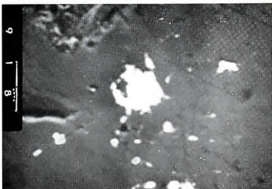
2. Zrna uraninitu v asfaltoidní hmotě antraxolitu [uranový antraxolit, nábrus]. Compo, rentgenový mikroanalýzátor JXA 50A, firma Jeol [Japonsko], zvětšeno asi 500 \times Foto A. Dubanský, K. Jurek
