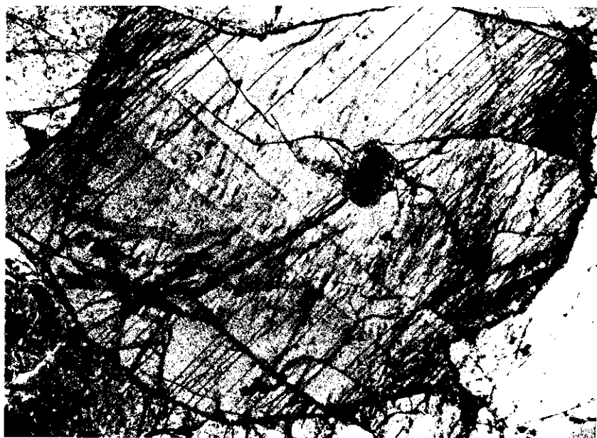
2. Zdvojitěný ortopyroxen z lherzolitové nodule v olivinickém nefelinitu lokality Záhoří u Javorníka. Jsou patrné odmišžené lamely a zaoblená inkluze olivínu. Zvětšeno 24X, X nikoly
