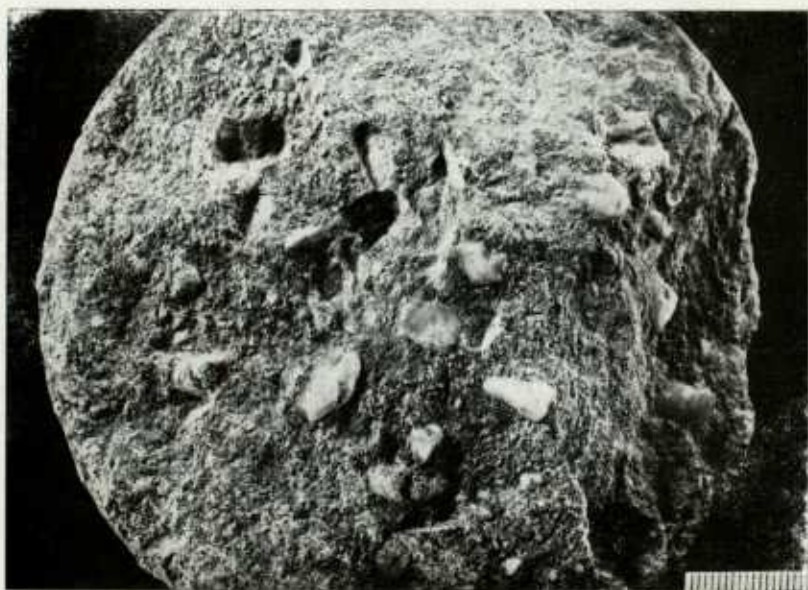
2. Valouny křemene a silicítů v glaukonitickém křemenném pískovci; korycanské vrstvy. Vrt BRA Brandýsek, hl. 24,8 m
