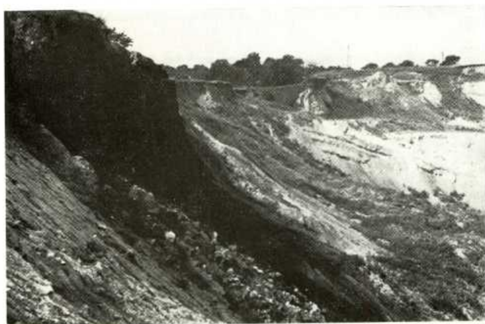
2. Vztyčený výchoz hnědouhelné sloje při břínském zlomu po j. okraji velkolomu Maxim Gorkij II s. od Břín; vpravo ukloněné vrstvy nadložních hornin 13. 8. 1963
