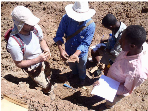
Zkoušení plasticity na vzorku jílu v zářezu nově budované silnice Hosaina – Lera.
