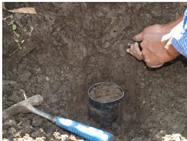
Odběr neporušeného vzorku v aluviální výplni kaldery Avonda plain
