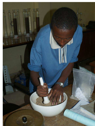
Zpracovávání vysušených vzorků pro zkoušku Atterbergových mezí.
