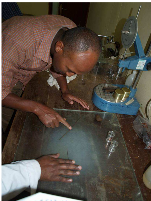
Zácvik ve stanovení meze plasticity odebraných vzorků.
