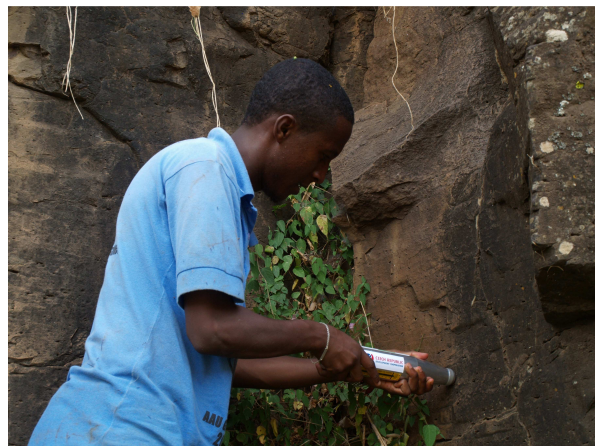
Měření Schmidtovým kladivem.
