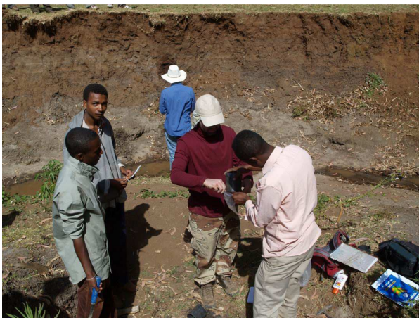
Odběr neporušeného vzorku HOS-3 a jeho vkládání do uzavíratelného obalu.
