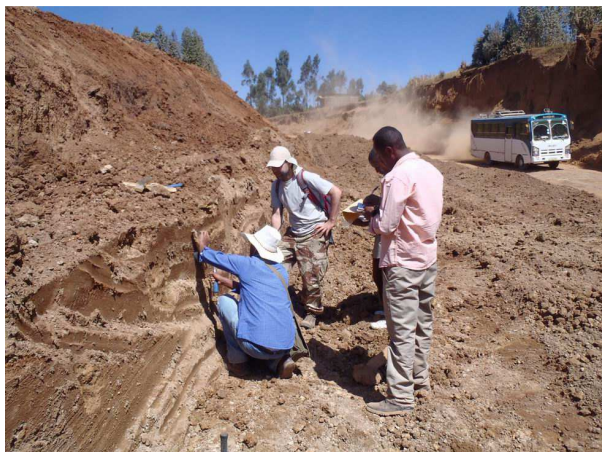
Odběr neporušeného vzorku v zářezu nově rozšiřované silnice Hosaina – Lera
