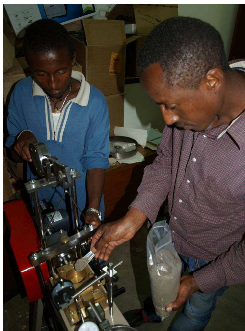
Osazování vzorku do krabicového smykového přístroje.
