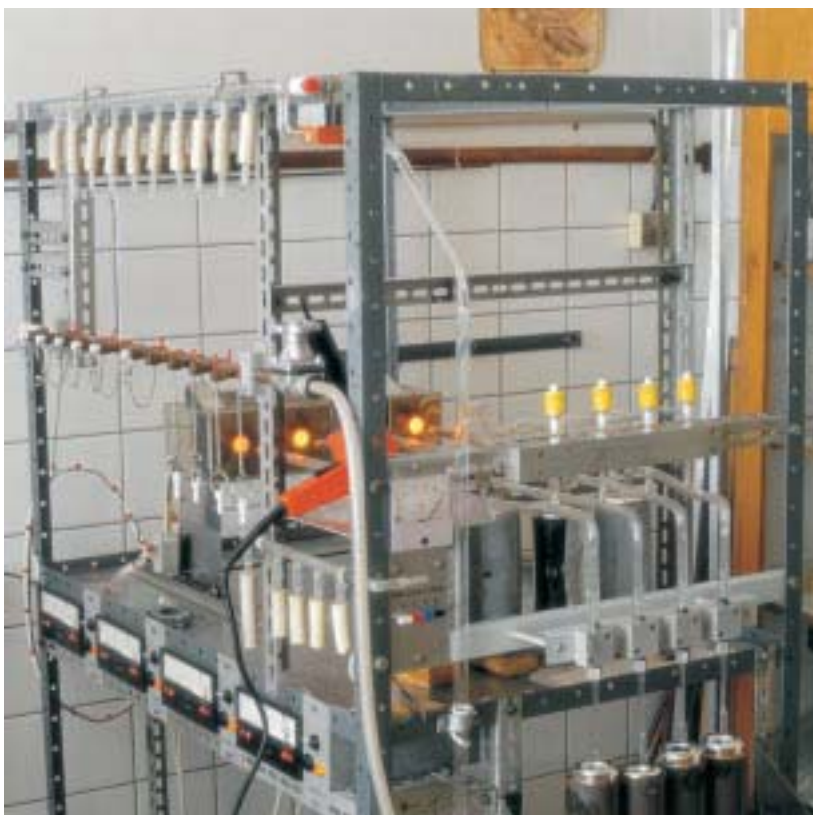
Obr. 50. Spalovací aparatura na rozklad sulfidů a sulfátů pro měření poměrů izotopů síry. Z laboratoří ČGÚ na Barrandově
