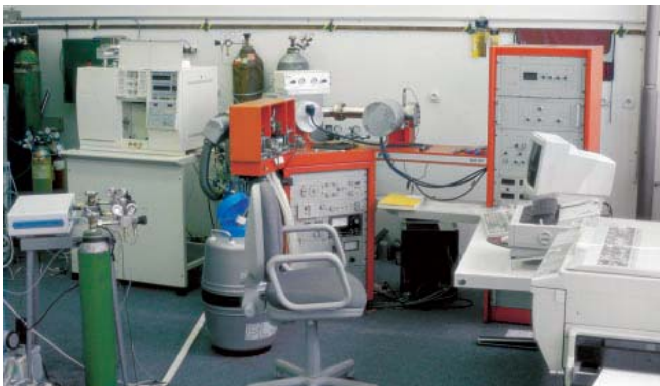
Obr. 51. Hmotnostní spektrometr Finnigan MAT 251 pro měření poměrů izotopů vodíku, uhlíku, kyslíku a síry. Z laboratoří ČGÚ na Barrandově
